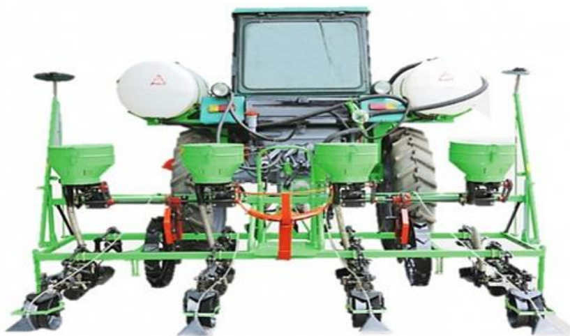
2-rasm. «OSHX-12-1A» gerbitsid sepish moslamasi
