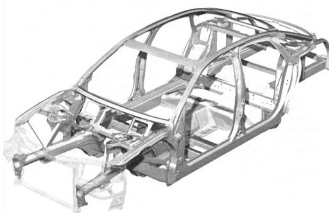
4.9-расм. Енгил автомобилнинг кўтариб турувчи кузов каркаси
