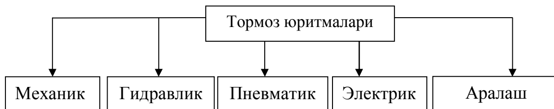
6.11-расм. Тормоз юритмасининг турлари
