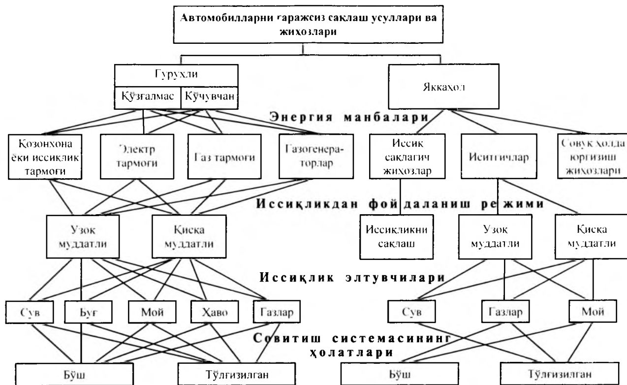
26.8- расм. Автомобилларни гаражсиз сақлашда двигателларни юргизиб олиш усуллари ва жиҳозлари таснифи.
