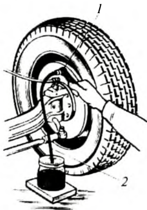
12.6- расм. Тормоз тизимидан ҳавони чиқариш.
