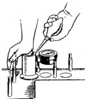
7.12- расм. Клапаннинг тозала-ниш сифатини текшириш.
