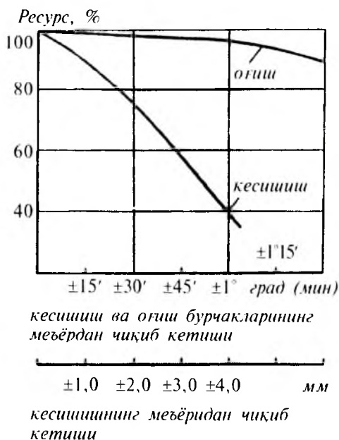
22.6- расм. Оғиш ва яқинлашув бурчакларининг шина ресурсига таъсири.
