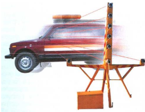
Rasm 8.1. Harakat jadalligi va tarkibini hisobga olishning avtomatlashtirilgan tizimi
