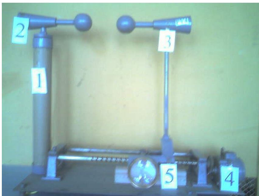
26.6-rasm. SHarlari 50 mm sharli voltmetrni umumiy ko‘rinishi: 1 – izolyator; 2 – potentsialli shar; 3 – erlangan shar; 4 - sharlarni orasidagi masofani rostlash uchun elektr motor; 5 – sharlarni orasidagi masofani o‘lchaydigan moslama.
