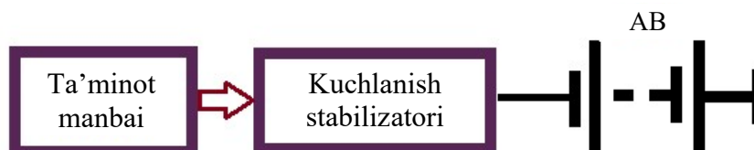
8.7-rasm. Zaryadlash qurilmasining strukturaviy sxemasi
