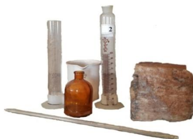
61 - rasm. Gilli gruntlarning granulometrik tarkibini aniqlovchi asboblari
