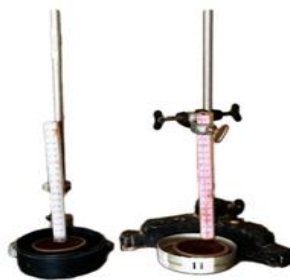
68 – rasm Gruntlarning kapillyar balandliklarini aniqlash asboblari
