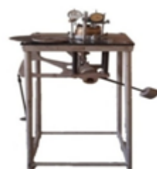
56-rasm. Gruntlarning siqilishini aniqlovchi kompression asbob
