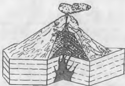
4.3-rasm. Vulqon o'chog'ining tuzilishi (M.M.Jukov, V.I.Slavin, N. N.Dunayevalar bo'yicha):
