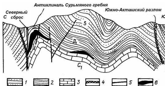
Рис. 9.2. Геологический разрез месторождения Кадамджай (по Н.А. Никифорову): 1 – песчано-сланцевые отложения; 2 – глинистые сланцы с прослоями гравелитов; 3 – массивные известняки; 4 – надвиги; 5 – прочие разломы; 6 – роговиково-джаспероидные брекчии с оруденением
