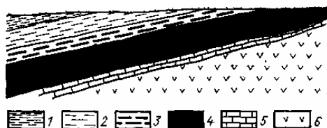
Рис. 7.1. Схематический геологический разрез Курейского месторождения графита (по С.В. Обручеву): 1 – песчаники; 2 – сланцы и кварциты; 3 – графитовые сланцы; 4 – графит, образовавшийся по пласту угля; 5 – карбонатные породы; 6 – диабазовые траппы
