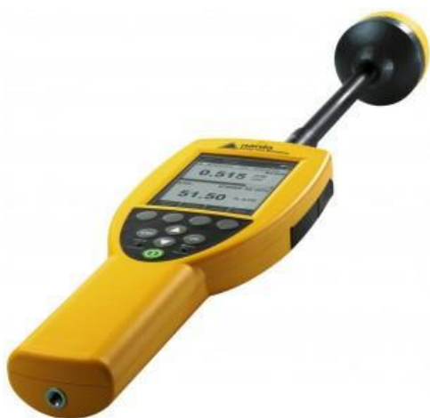
8.2-rasm. Elektr va magnit maydon kuchlanganligini o'lchovchi asbob (Narda NBM- 550)
