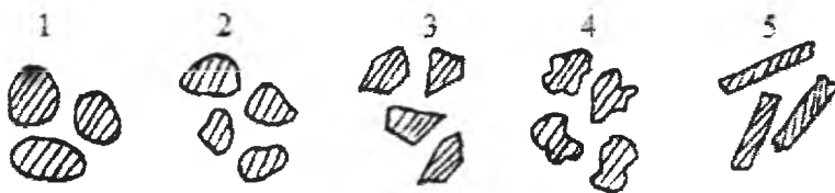
7-rasm. Yirik donali va qumli gruntlar donasining shakli: 1 – dumaloq; 2 – yarim dumaloq; 3 – burchakli; 4 – murakkab ko'rinishli; 5 – uzunlashgan-plastinkali.
