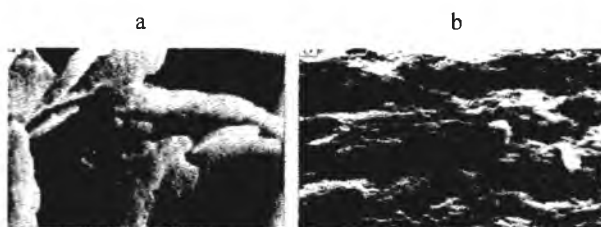
21-rasm. Gillardagi «bazi-bazi» turdagi (a) kam zichlashtirilgan va (b) zichlashtirilgan koagulyatsion tutash joy.
