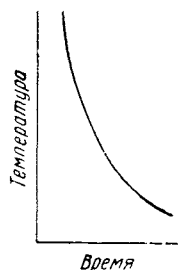
Рис. 268. Кривая охлаждения без фазовых превращений
