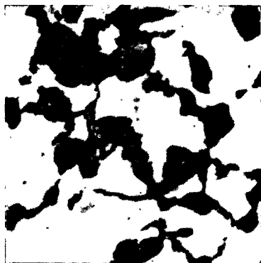
Рис. 55. Эвтектоидная сталь после частичного превращения в результате непрерывного охлаждения с промежуточной скоростью: светлые участки — мартенсит, темные — перлит и бейнит. \times 500
