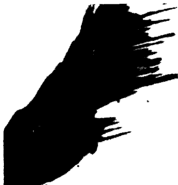
Рис. 50 Бейнит в углеродистой стали после неполного превращения. \times 1500
