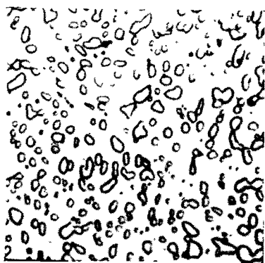
Рис. 56. Эвтектидная сталь, в которой \text{Fe}_3\text{C} сфероидизован длительным нагревом при температуре немного более низкой, чем температура эвтектичного равновесия (сравни с рис. 48, А). \times 1500
