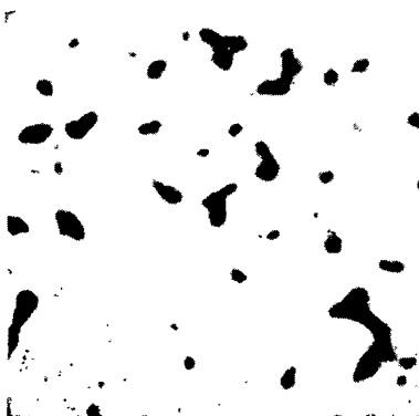
Рис. 74 Литой доперитектический сплав Pt+25% Ag:
