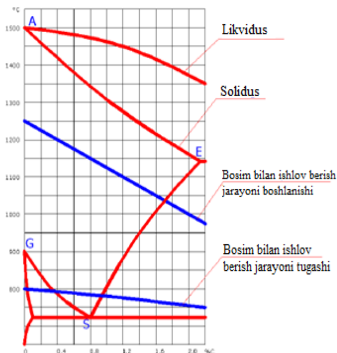
2.2-rasm. Uglerodli po‘latlarni bosim ostida issiq holda ishlov berish temperaturasi intervali
