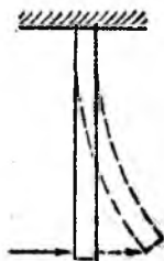
1.3-rasm. Elastiklikni xarakterlovchi deformatsiya (yuklama olingandan soʻng namuna oʻzining dastlabki vaziyatiga qaytadi)
