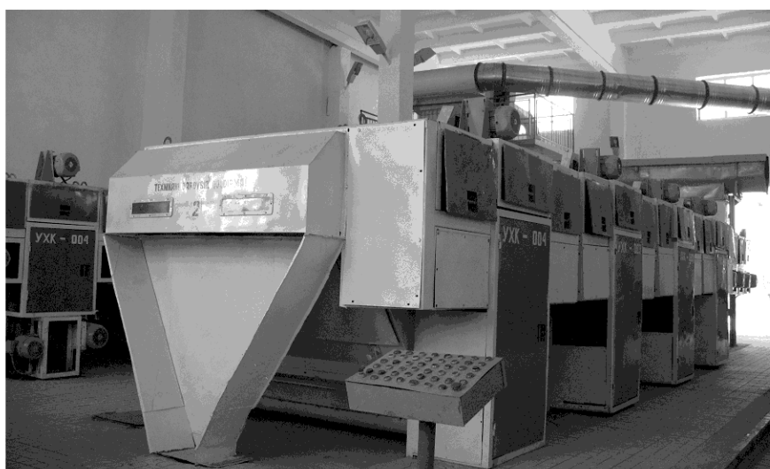
18-rasm. 1XK rusumli chigitli paxtadan mayda iflosliklarni toza lash mashina sining umumiy ko'rinishi.
