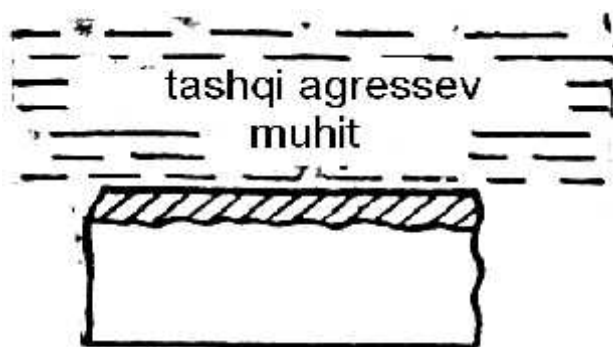
6.1.1-rasm, a) tekis korroziya.
