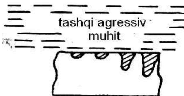
6.1.1-rasm, b) mahalliy korroziya.
