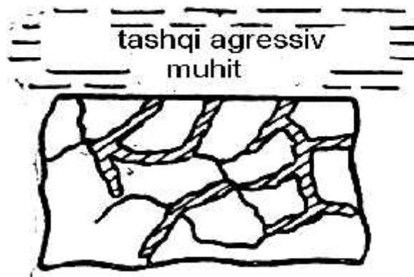
6.1.1-rasm, v) kristallitlararo korroziya.
