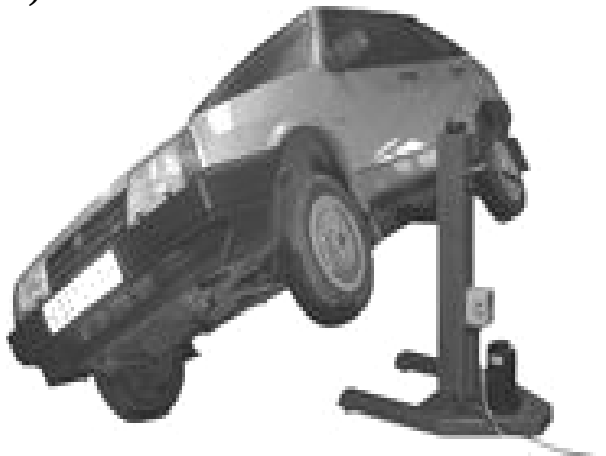
5.25-rasm. Ag'dargich. a - umumiy ko'rinishi; b- ag'darish jarayonida
