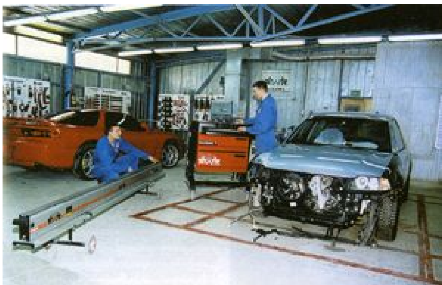
2.22-rasm. Ultratovush yordamida kuzov geometrik o'lchamlarini aniqlash posti
