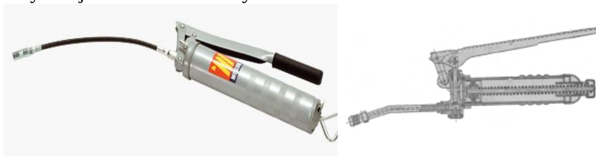
4.30-rasm. 3102- MECLUBE rusumli qo'l shpristi va sxematik ko'rinishi
