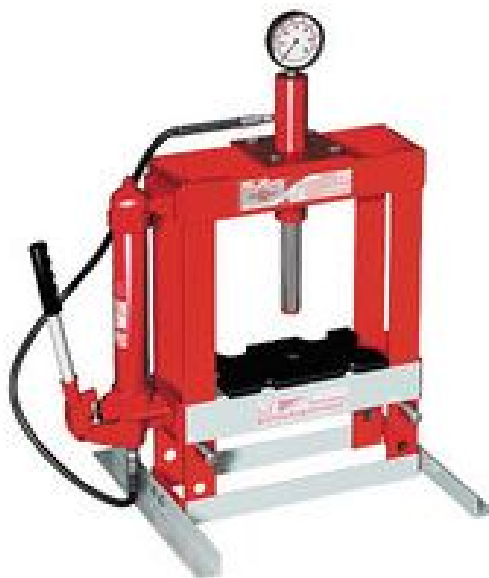
5.11-rasm. 5.2125-rusumli stol ustida joylashuvchi gidravlik press, 10 t.
