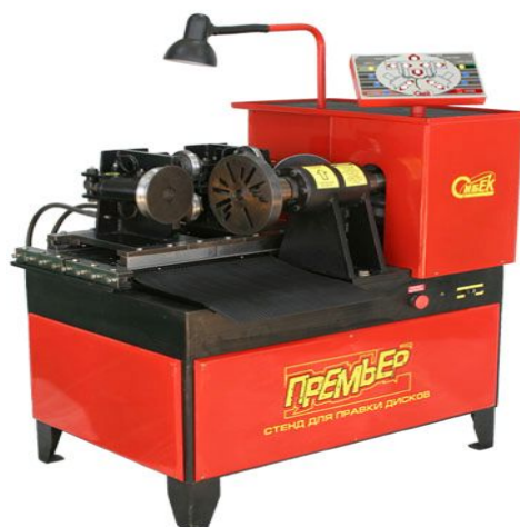
4.27-rasm. Premier rusumli avtomobil g'ildiraklari diskini to'g'rilash jihozi.
