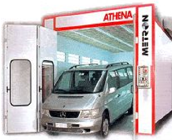
2.26-rasm. «ATHENA 70/24 S» modelli bo'yoqlash quritish kamerasi
