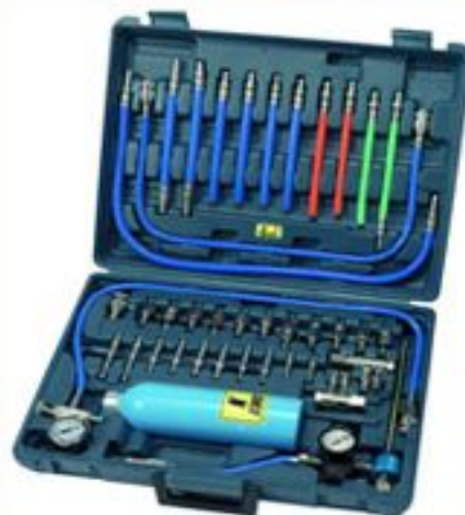
3.4-rasm. Injektorlar tizimini tozalash majmuasi.
