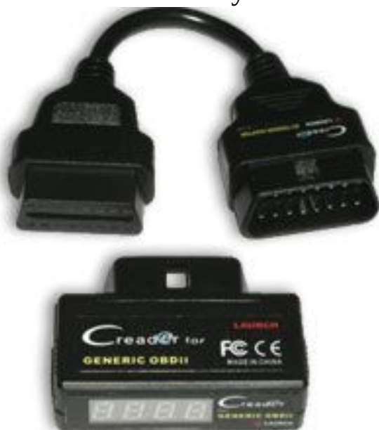
3.16-rasm. VAG i OBDII guruhidagi avtomobil-lardagi nosozlik kodlarini o'qish pribori – Creader
