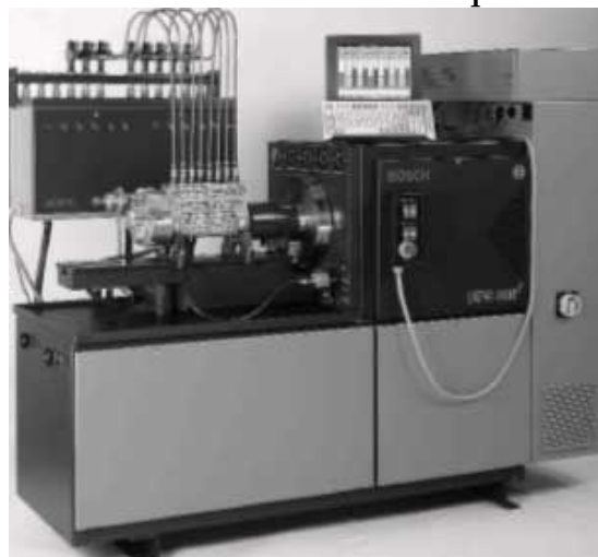
3.10-rasm. Yuqori bosimli yonilg'i nasosini sinash jihozi
