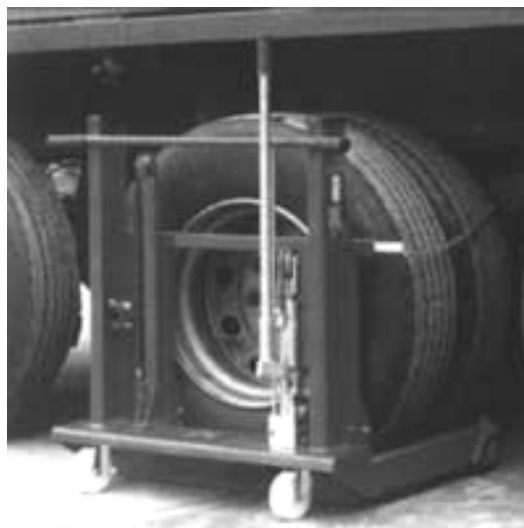
4.19.-rasm. Avtomobillar g'ildiraklarini yechib olish, o'rnatish va tashish uchun aravacha. a- umumiy ko'rinishi; b- ish jarayonida.
