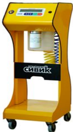
3.3-rasm. Yonilg'i ta'minoti tizimini tekshirish va yuvish jihozi
