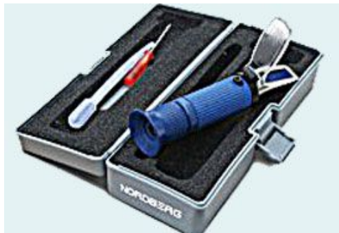
3.15-rasm. Elektrolit zichligini tekshirish areometri va yordamchi asboblari
