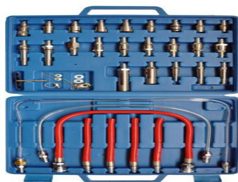
4.11-rasm. ATF3000 modelidagi avtomat uzatmalar qutisini yuvish va undagi suyuqlikni almashtirish jihozi
