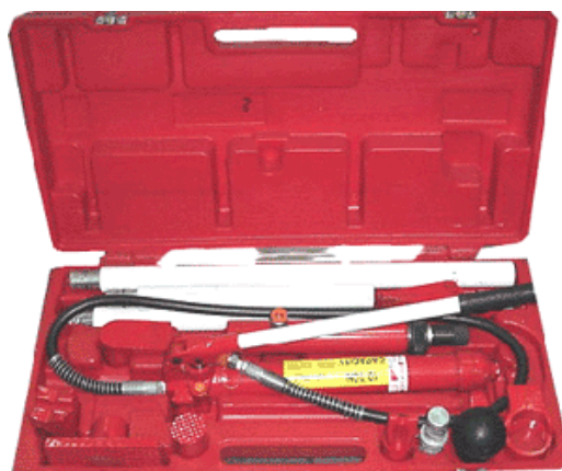
2.19-rasm. Kuzovlarni gidravlik to'g'rilash jamlanmasi
