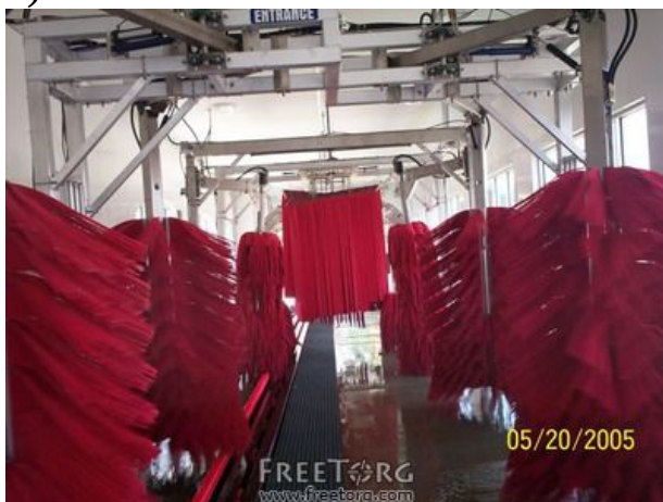
2.7-rasm.Yengil avtomobillarni yuvish va quritish oqimli qatori: a-avtomobillarni cho'tkali yuvish jihozi; b-avtomobillarni quritish jihozi
