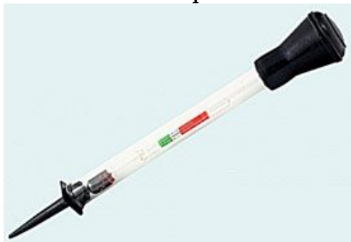
3.15-rasm. Elektrolit zichligini tekshirish areometri va yordamchi asboblari
