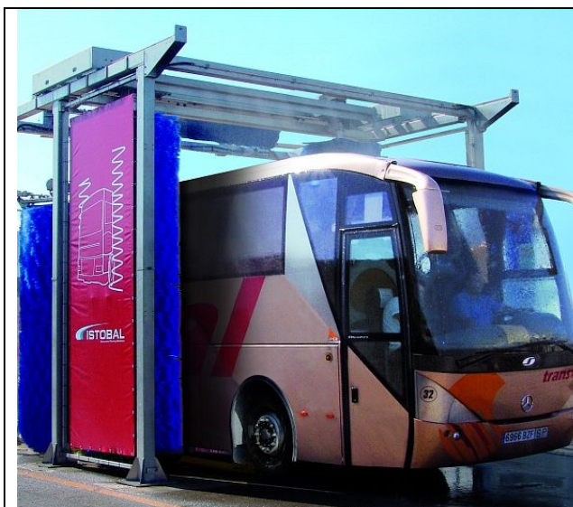
2.9-rasm. ISTOBAL modelidagi yuvish uskunasi
