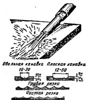
Рис. 9.33. Схема поверхностной кислородной резки и формы выплавляемых канавок
