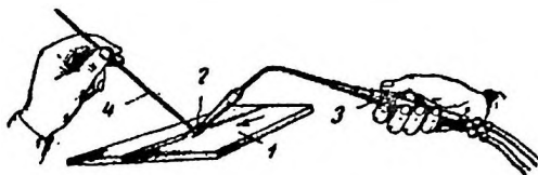
Рис. 1.2. Ручная газовая сварка.
