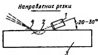
Рис. 9.17. Схема процесса поверхностной резки:
