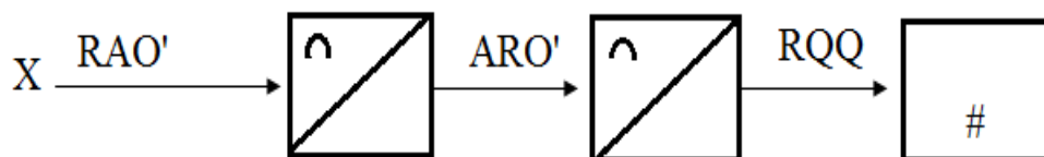
1.2-rasm. Raqamli o'lchash asbobining funksional chizmasi. RAO' – raqamli- analog o'zgartkich; ARO' - analog-raqamli o'zgartkich; RQQ- raqamli qayd etish qurilmasi
