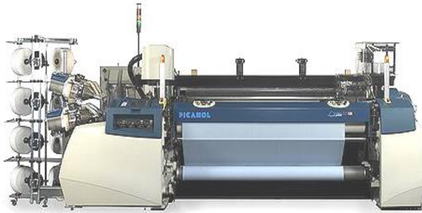
1.12-rasm. Picanol OMN plus 800 dastgoxi
