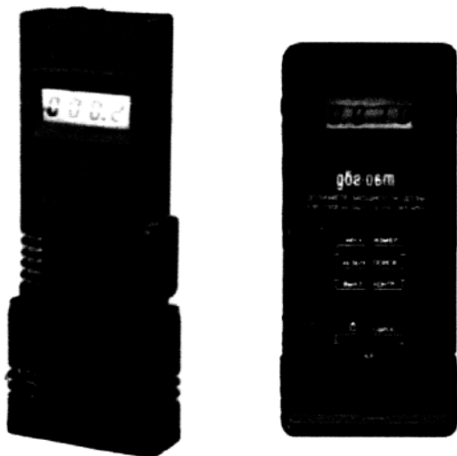
8.1.-rasm. A) DKC-04 doimiy foton nurlanishining ta'sir qilish dozasining kuchi va beta nurlanishining mavjudligini sifatli baholovchi dozimetrlar, b) DBG-06T foton nurlanishining dozasiga teng ta'sir qilish quvvatini aniqlovchi dozimetrlar
