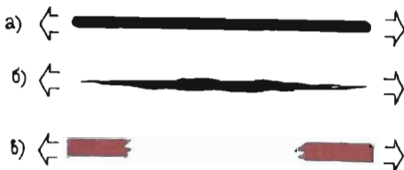
46-расм. Чўзувчи куч таъсирида резина тасма ва пластилин парчаси чўзилади, қоғоз варағи эса йиртилиб кетади.
