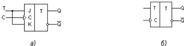
Рис. 7.11. Счетный триггер а) схема б) условное обозначение
