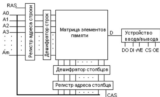
Рис. 12.5. Структурная схема микросхемы DRAM
