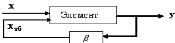
2.3-расм. Тескари боғланишга эга элемент
