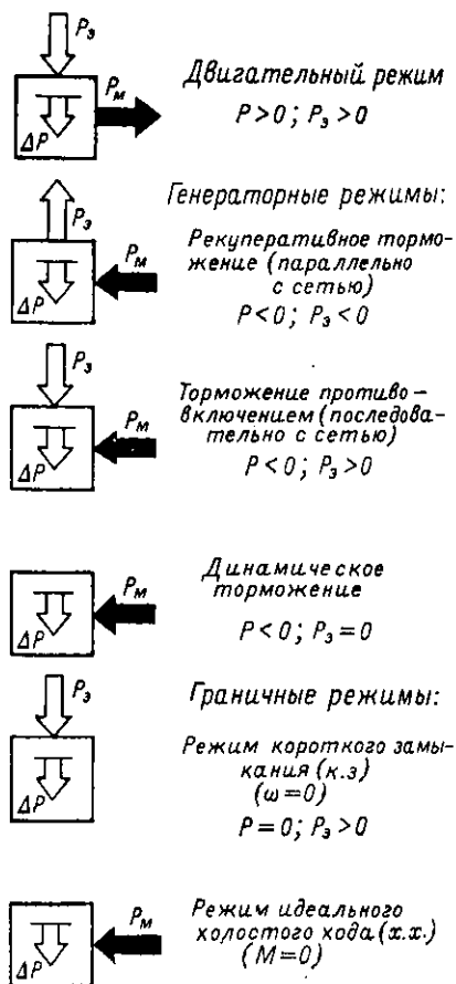
Рис. 1-10. Энергетические диаграммы режимов работы двигателя.
