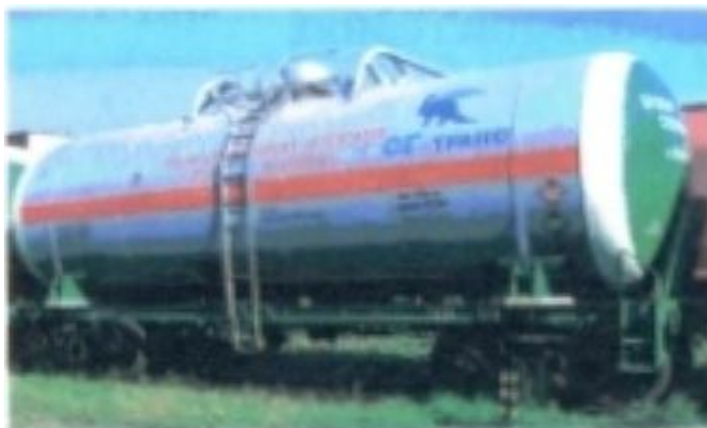
8.4-rasm. Suyultirilgan Neft gazni tashishda qo'llaniladigan vagon – sisternaning tashqi ko'rinishi.
