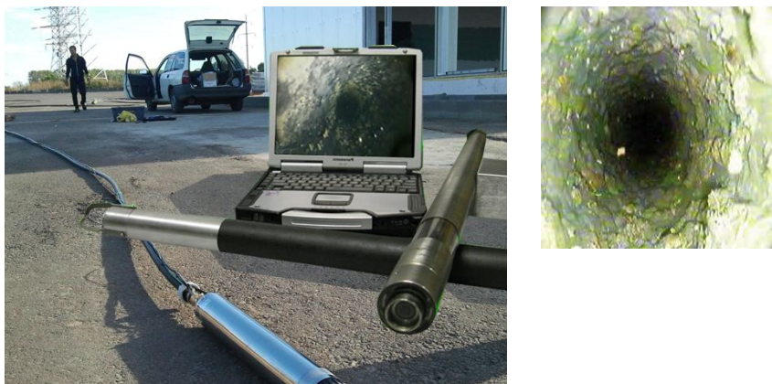
Рис.12.2 Оборудование для видеокаротажа
