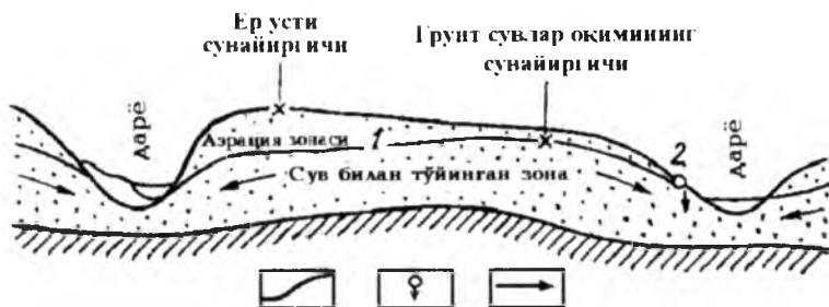
9.7-расм. Дарёлар оралиғи массивлари чизма қирқими: 1-грунт сувлари сатҳи, 2-булоқ, 3-грунт сувлари оқимининг ҳаракат йўналиши
