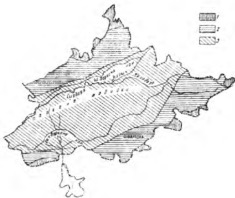
10.7-расм. Фарғона артезиан сув ҳавзасининг гидрогеологик районлаштириш чизмаси (А.Н.Султонхўжаев ва В.А.Гейнц бўйича). 1-юқори тоғли мингтақалардаги ерик сувлар ҳавзаси; 2-адир мингтақасидаги артезиан сувлар ҳавзаси; 3-текислик мингтақасидаги артезиан сувлар ҳавзаси
