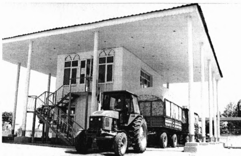
1-rasm. Chigitli paxtani qabul qilishda, uning vaznini aniqlash uchun ishlatiladigan ikki tomonli tarozi.
