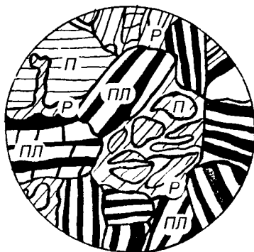
Рис. 5. Габбро под микроскопом: ПЛ — плагиоклаз, п — пироксен, р — роговая обманка.
