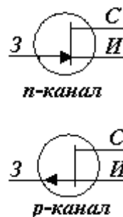
11.1 – расм. n – каналли МТ тузилмасининг кўндаланг кесими (а) ва унинг шартли белгиланиши (б).
