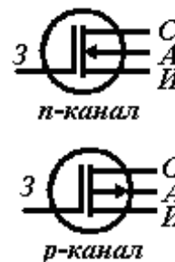
13.1 – расм n – канали қурилган МДЯ – транзистор тузилмаси (а) ва унинг шартли белгиланиши (б).
