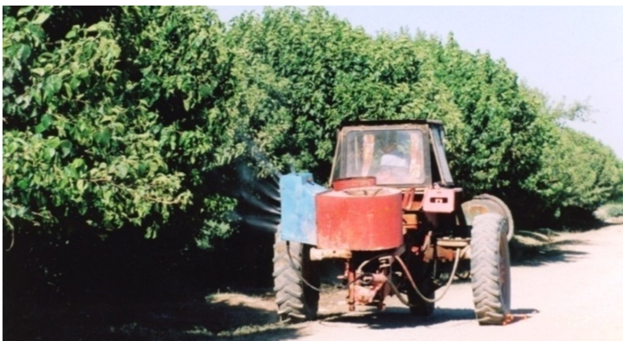
45-расм. Тутларга ишлов бериш ҳамда баландлик бўйича қамраш кенглигини оширишга мўлжалланган махсус мослама билан жиҳозланган ОВХ-28 пуркагичи (Хўжаев маълумоти бўйича).
