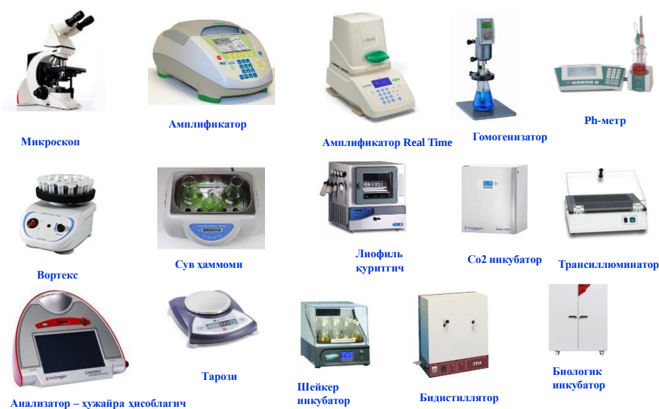
1.9-rasm. Biotexnologiya laboratoriyasining asosiy uskunalari
