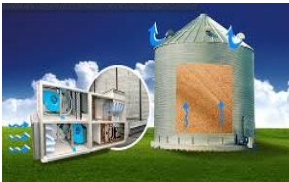
5.5-расм. Сақлаш омборларида донларни фаол шамоллатиш
