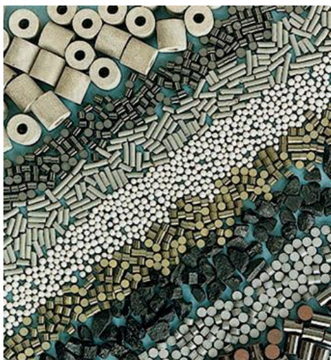
11.1-rasm. Geregogen katalizda qoʻllaniladigan turli shakldagi katalizatorlar.
