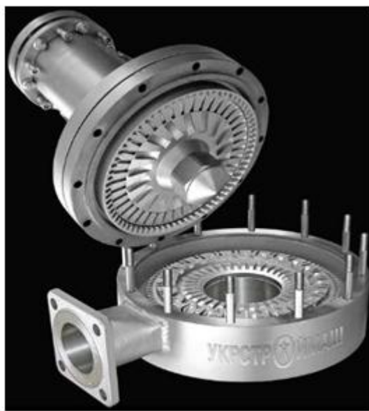
13.4 rasm. Kolloid tegirmonning umumiy ko'rinishi va ishchi qismi 42 .
