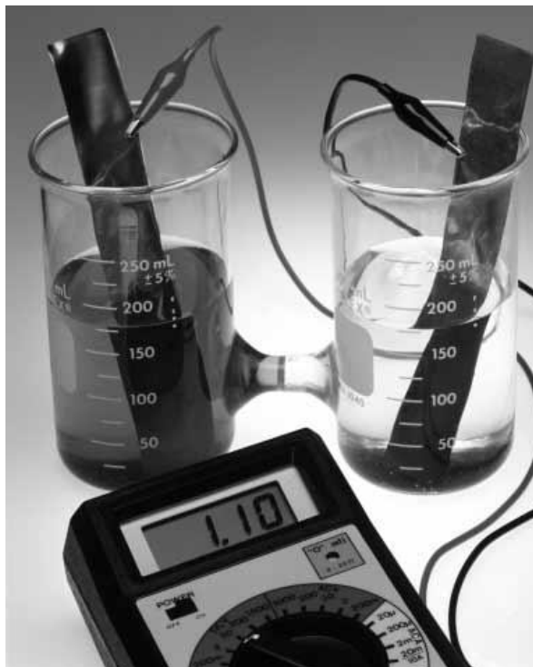
9.3 rasm. Oksidlanish-qaytarilish reaksiyasi ikkita idishda olib borilgan 33 .
