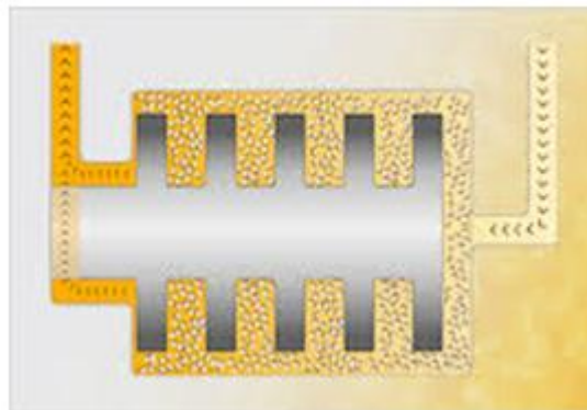
13.6 rasm. Biser va biser tegirmonining ishlash sxemasi.
