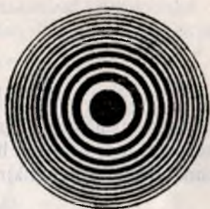
5.12.2- rasm. Yorug'lik nurining interferension manzarasi.
