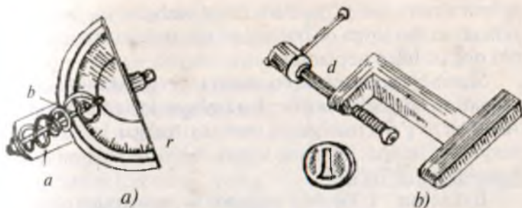
1.5.2- rasm. Ballistik to'pponcha va uni tayanchga mahkamlaydigan qisqichning sxematik tasviri.
