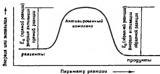
Рис. 1.63. Схематическое представление изменений энергии, сопровождающих химическую реакцию. Максимум на кривой соответствует активированному комплексу
