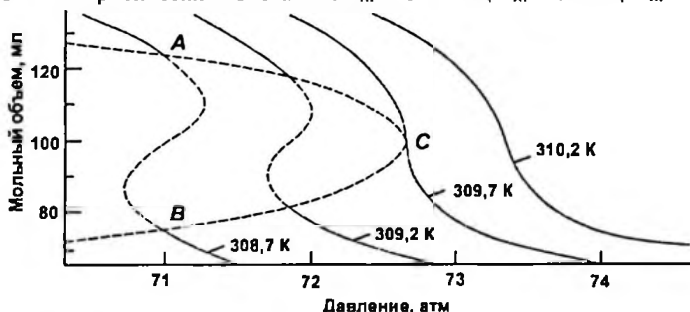
Рис. 1.2. Кривые, рассчитанные по уравнению Ван-дер-Ваальса, показывающие зависимость мольного объёма азота от давления для четырёх значений температур
