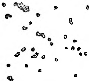
Рис. 2.17. Так выглядят коллоидные частицы серебра в электронный микроскоп (увеличение в 100000 раз)
