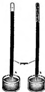
Рис. 1.1а. Способ определения молекулярного веса вещества по методу ртутной колонки (метод Гофмана). Современный прибор представлен в третьей части книги (рис. 3.1.)
