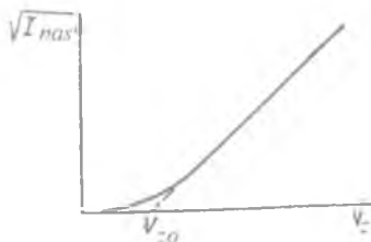
8.15-rasm. MDYa maydonli tranzistori to'yinish tokining boyitish rejimida zatvor kuchlanishiga bog'liqligi
