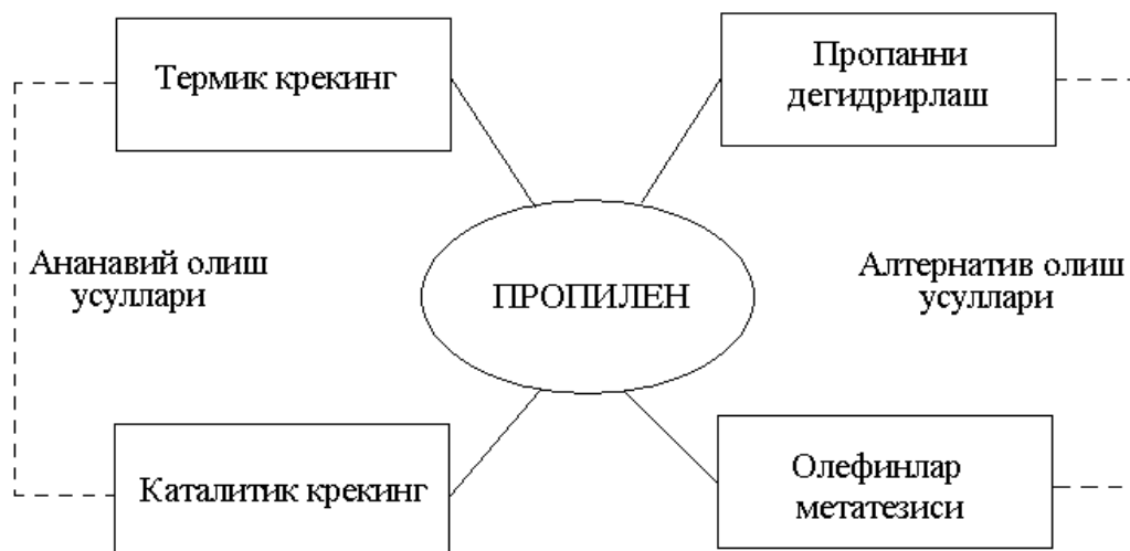
1-расм. Пропиленни саноат миқёсида ишлаб чиқариш усуллари Энди пропанни каталитик дегидрирлаш жараёни билан танишамиз. Ушбу жараён негизда қуйидаги реакция содир бўлади:
