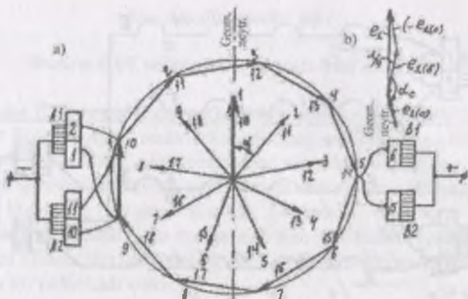
29-rasm. a) 27-rasmda tasvirlangan chulg'am seksiyalar EYKlarining yulduzi va ko'pburchagi; b) 1-seksiya EYKining yo'nalishini aniqlash uchun vektor diagramma
