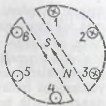
8.11-rasm. Stator chulg'amida uch fazali tokdan hosil bo'ladigan aylanuvchi magnit maydon:
