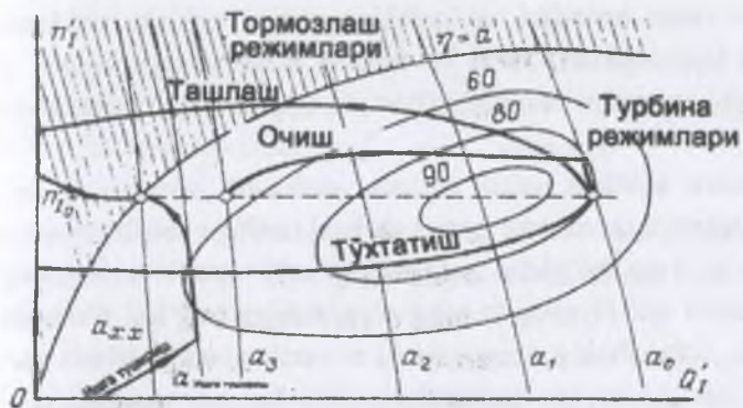
5.3- rasm. Bosh universal xarakteristika maydonida o'tish jarayonlari-ning trayektoriyalari
