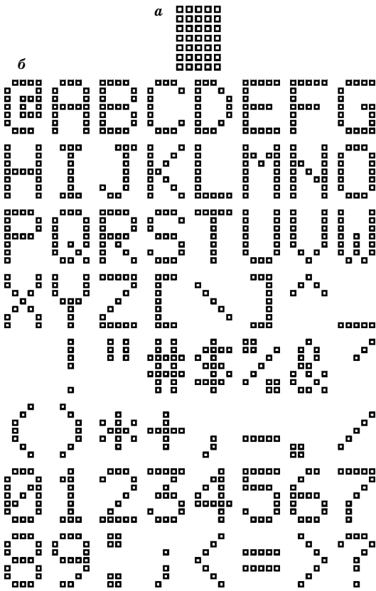
Рис. 8.26 Полный точно-матричный шрифт: a — формат 5x7; б — типичный набор символов кода ASCII.
