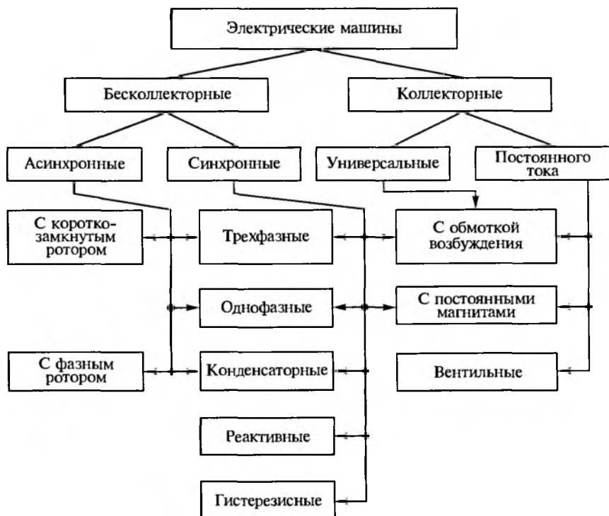
Рис. 1.2. Классификация электрических машин
