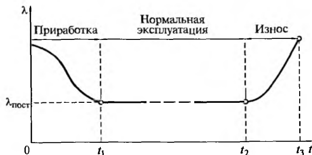
Рис. 2.12. Интенсивность отказов для трех периодов работы электрической машины
