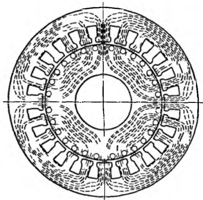
Рис. 3.3. Магнитная система четырехполюсной ( 2p = 4 ) асинхронной машины
