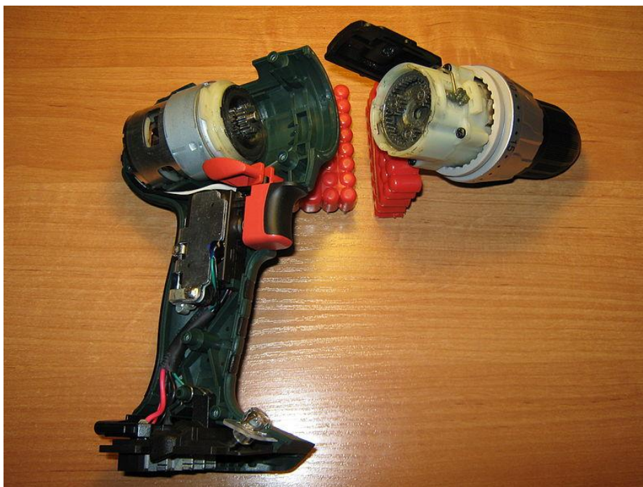
3.4.7-rasm. Planetar uzatmani elektrdredlda qo`llanishi
