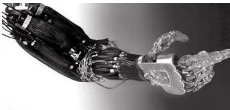
2.4.3-rasm. Oldindan dasturga kiritilmagan topshiriqlarni bajarishga mo`ljallangan protez uchun ishlatiladigan manipulyator
