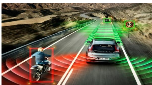
2.3.5-rasm. Adaptiv kruiz-kontrol tizimining asosiy vazifalari
