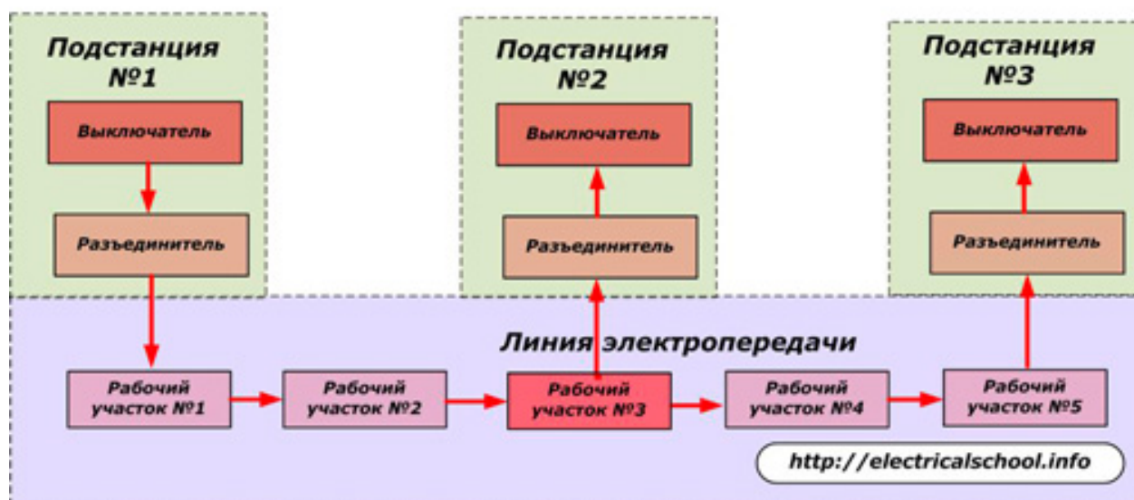
Местоположение разъединителя в электрической схеме
