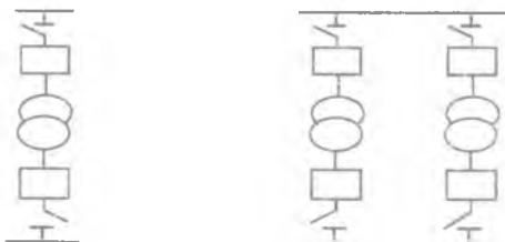
8.2-rasm. Kuch transformatorlarning soni va quvvatlarini tanlash.
