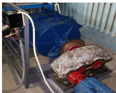
Рис. 2. Стенд на базе лабораторной барабанной мельницы
