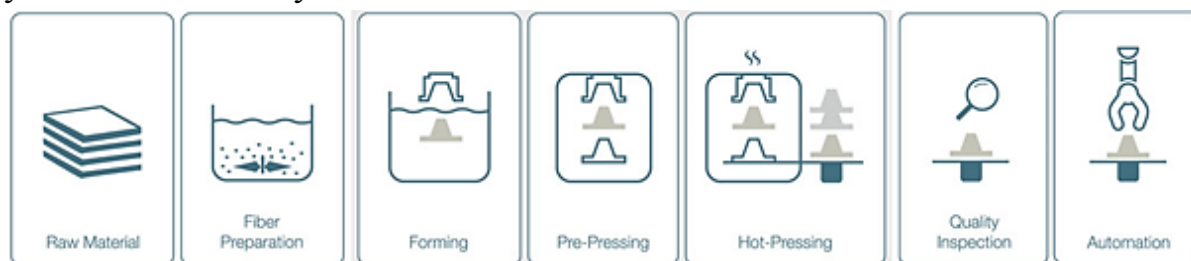
Рис. 2. Основные этапы производства литых изделий
