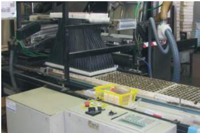
Кассета ва тувакчаларни аралашма билан тўлдириш ҳамда уруғ экишнинг автоматлашган тизими
