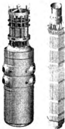
3.20-rasm. VVER-1200 reaktori korpusi va issiqlik ajratib chiqaradigan to'plam (TVS).
